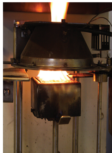
SINTEF NBL undersøker også branntekniske egenskaper til kabler. Her utføres testing i konkalori-meteret (ISO 5660).
