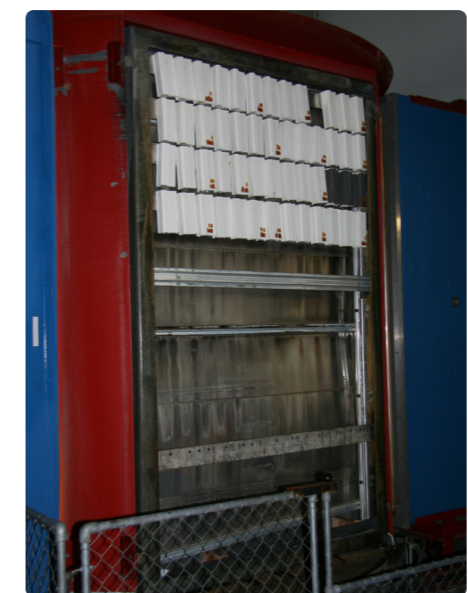
Fig. 3 Akselerert klimaaldring av malte treprøver i vertikal klimasimulator
