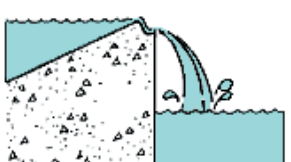
Fig. 531 d Utkasterkant og vannslør
