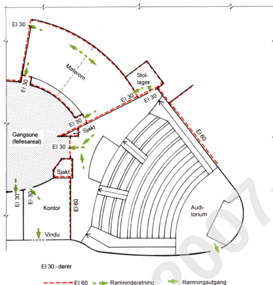
Fig. 13 b Forsamlingslokale. Eksempel på brannteknisk tegning
