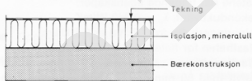
Fig. 01 Kompakt tak isolert med mineralull
