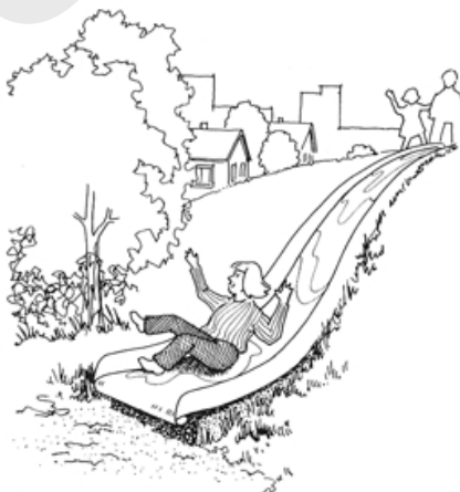
Fig. 51 b Rutsjebaner kan med fordel legges i terrenget, noe som reduserer risikoen for fallskader.
