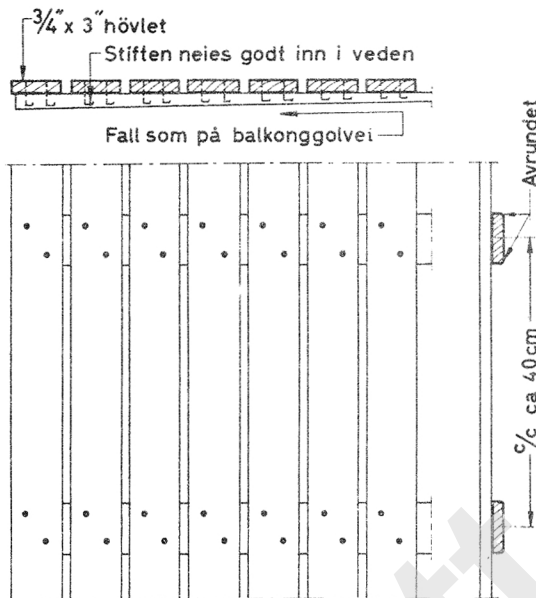
Fig. 23. Tremmegolv til beskyttelse av vanntett belegg.
