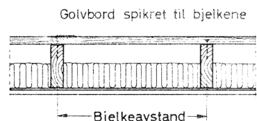
Fig. 22b. Bjelkeavstanden er regnet fra midte til midte av bjelkene.
