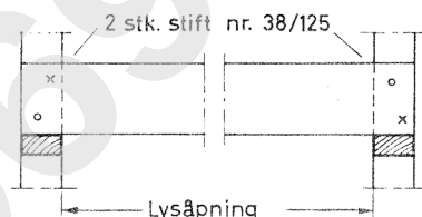
Fig. 22a. Hvis bjelkene spikres til bindingsverket, får bjelkelaget ekstra stivhet.
