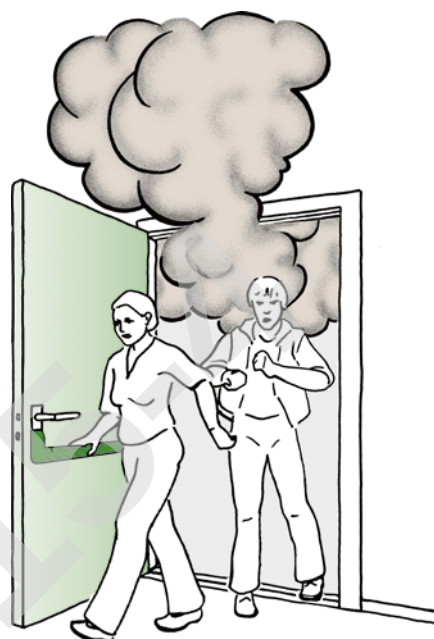
Fig. 21 Panikkbeslag på dør i rømningsvei fra forsamlingslokale o.l. I en panikksituasjon åpnes døra ved oppstuvning og press på beslaget.
